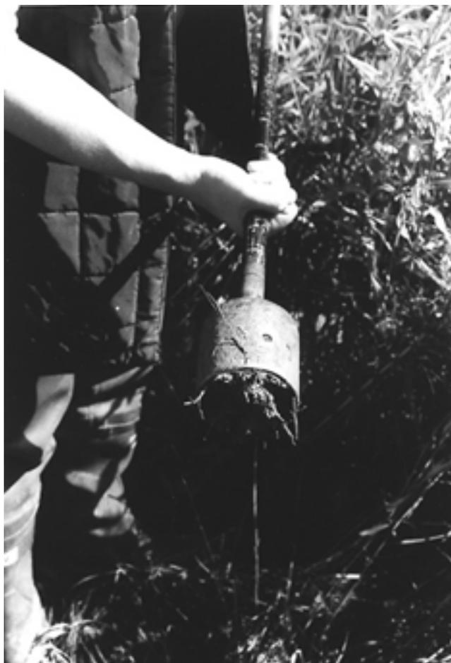
Figura 2.4 - Carotatore utilizzato per il prelievo del campione di suolo.
